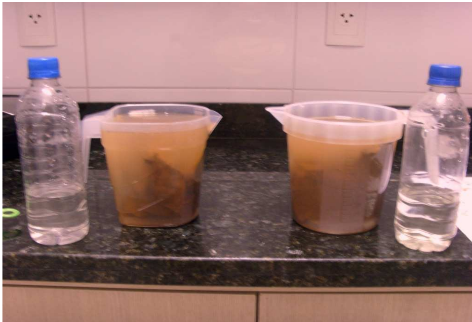
Figura 9 - Tecidos sujos imersos em solução. Da esquerda para direita - água sanitária ecológica, da direita para esquerda - água sanitária comercial.
