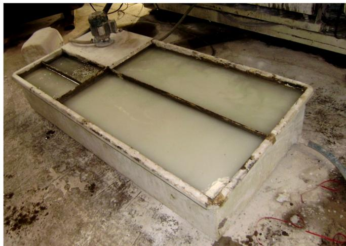
**Figura 4:** Caixa coletora e de decantação da água utilizada em reciclo no processo de lapidação e polimento do vidro
