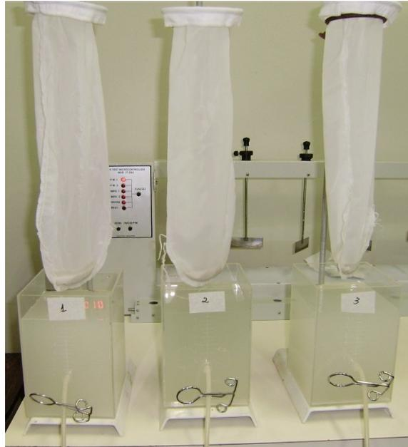
**Figura 13** – Ensaio de coagulação/precipitação seguido de filtração do efluente em estudo
