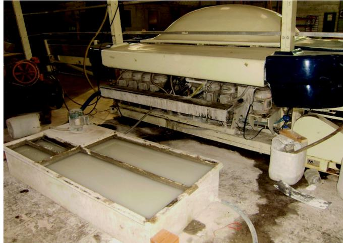
**Figura 5:** Caixa coletora acoplada ao equipamento de lapidação e polimento de vidro
