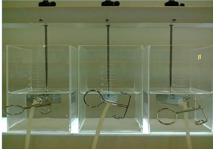
**Figura 11** – Ensaio em triplicata após o ensaio de coagulação/precipitação com o polímero auxiliar de coagulação.
