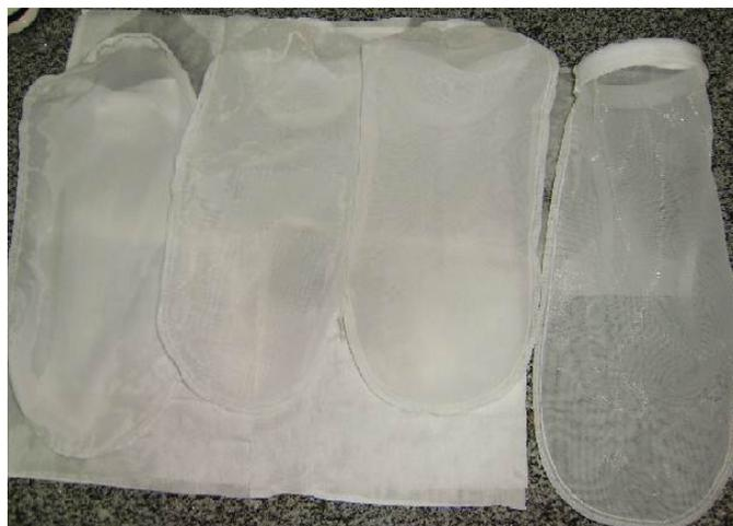
**Figura 3:** Bags tipo polifilamento de nylon (PFNY) utilizados na filtração
