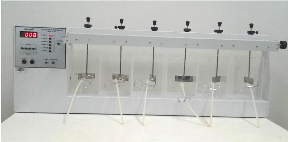
**Figura 2:** Aparelho de jar-test utilizado nos ensaios físico-químicos
