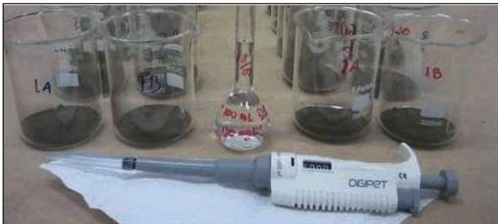
**Figura 19.** Contaminação da amostra com 1 mL de *surrogate* a 130 ppm
