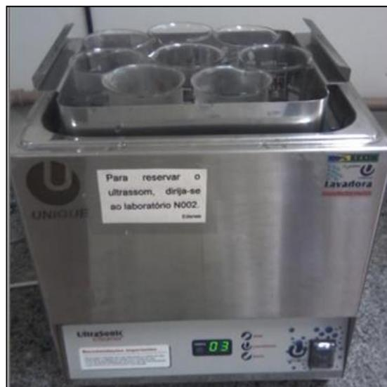
**Figura 19.** Extração em ultrassom para o ensaio de recuperação
