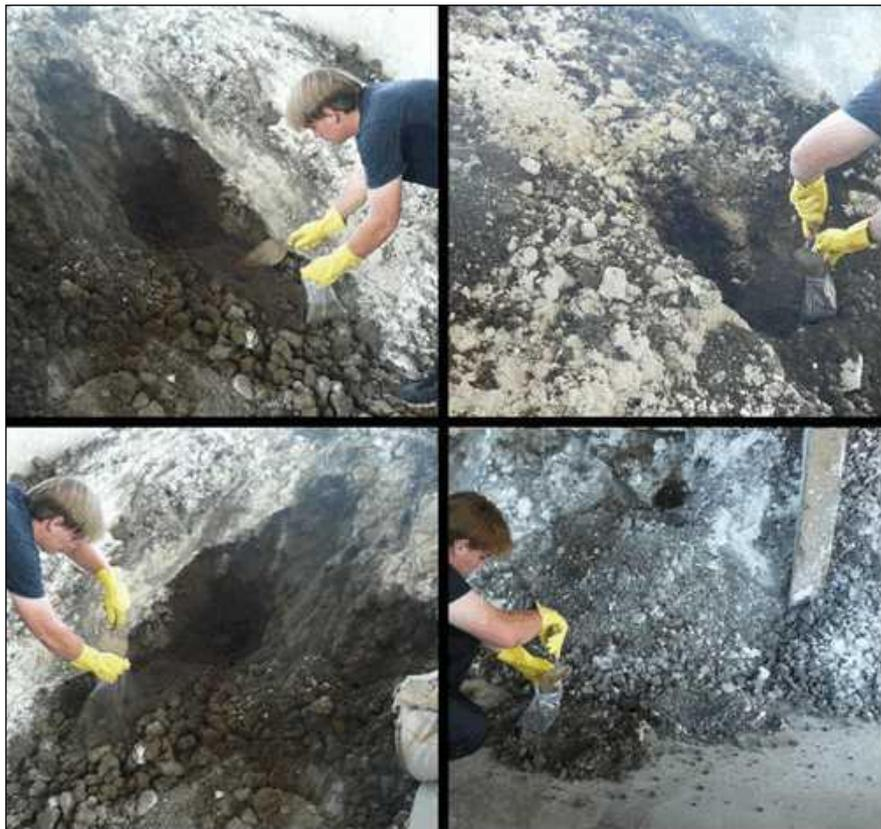
**Figura 12.** Amostragem nas Baias de Estocagem de Lodo na ETE de Pato Branco, Paraná.
