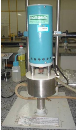
Figura 12 – Moinho de facas utilizado para moer as ervas aromáticas.
