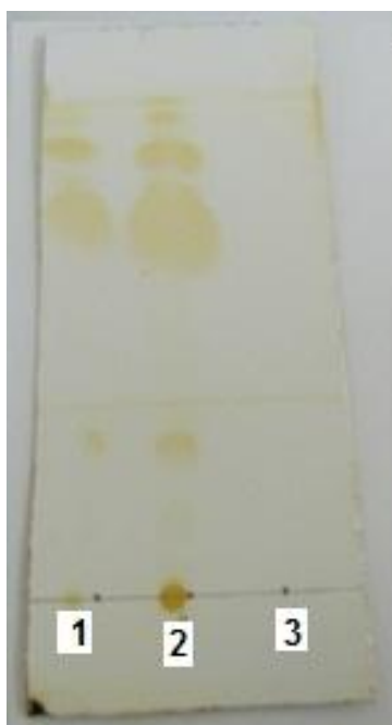
Figura 9 - Cromatoplaça : 1 lavagem do papel filtro, 2 resíduo da filtração e 3 cristais
