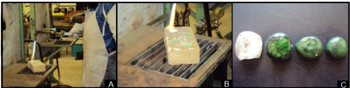
Figura 3 – Amostras sendo fundidas em maçarico (A e B) e amostras prontas nas suas diferentes concentrações
