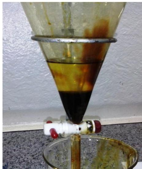
**Figura 13: Fracionamento líquido-líquido em funil de separação com o EMQa.**
