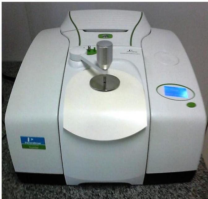
**Figura 16: Espectrofotômetro de Infravermelho com transformada de Fourier e acessório UATR.**
