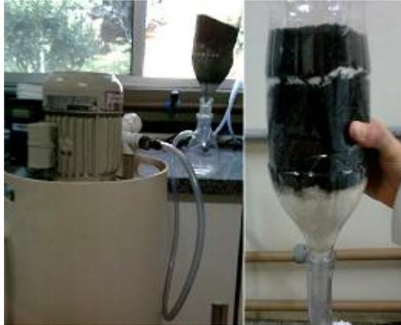
**Figura 13 – Filtro com carvão ativado acoplado a bomba a vácuo**
