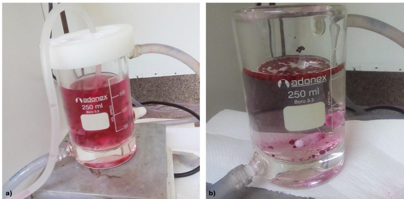
Figura 8 – Reator fotoquímico utilizado durante os ensaios de degradação do corante. a) Antes do tratamento. b) Após um dos tratamentos contendo esferas de quitosana com nFZV.
