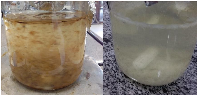
Figura 7 – Processo de despigmentação da quitina. Início do processo à esquerda, e, produto final à direita.
