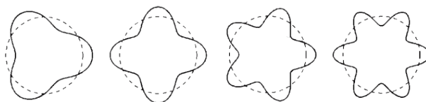
Figura 6 – Modos de oscilação possíveis para um elétron ligado. Respectivamente n = 3 , n = 4 , n = 5 e n = 6 .
