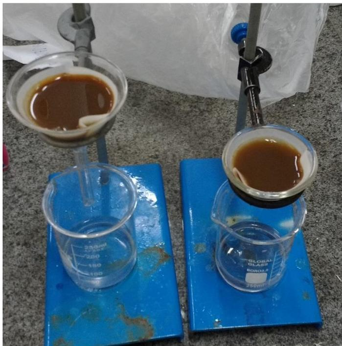
**Figura 6** - Filtração do hidróxido de cobalto precipitado
