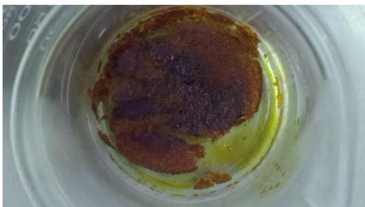
**Figura 7** - Cloreto de cobalto obtido após o tratamento do resíduo
