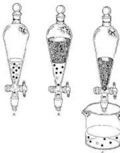
Figura 9 – Processo de extração. Em “A”, é introduzido o solvente 1 que contém uma mistura de moléculas (brancas e pretas). Em “B”, o solvente 2 (sombreado), após a agitação, contém a maior parte das moléculas brancas, as quais foram extraídas para o novo solvente. Em “C”, com a remoção da fase inferior, tem-se a mistura parcialmente separada.
