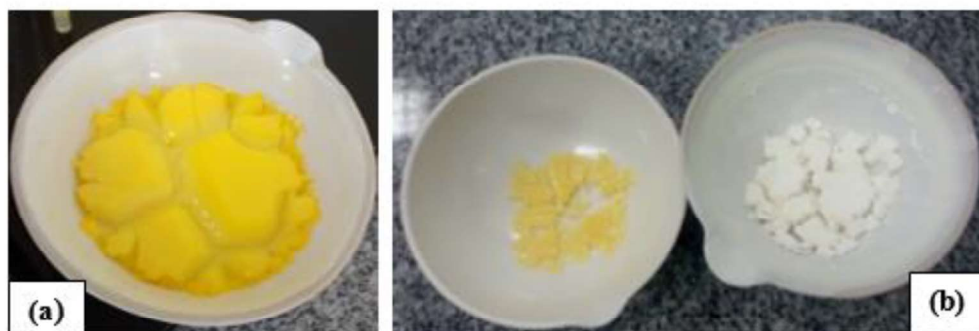
Figura 12 - Etapas da síntese do O.S. dopado. (a) sol gel; (b) antes e após a calcinação.
