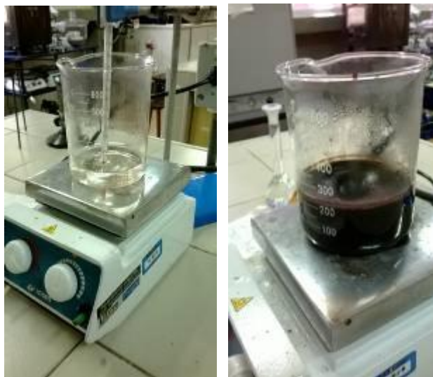
Figura 3 - Solução de NaOH em aquecimento e solução depois de adicionado os íons metálicos.
