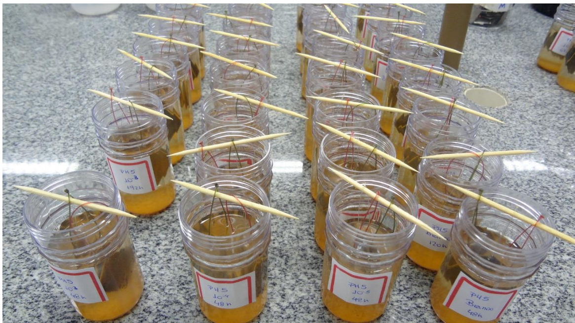
Figura 4 - Fotografia dos ensaios de corrosão após 24 horas de imersão do pH =5,0 Fonte: Autoria própria
