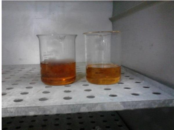
**Figura 7 - Aquecimento do Biodiesel na Estufa**
