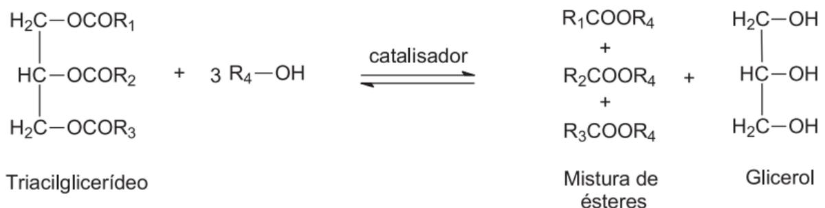
**Figura 2 – Esquema de reação de transesterificação**
