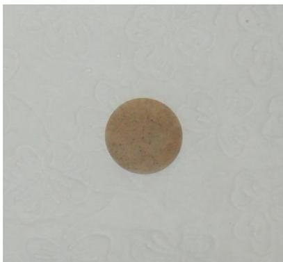
**Figura 4- Pastilha de KBr com amostra de ácido húmico para análise de FTIR**
