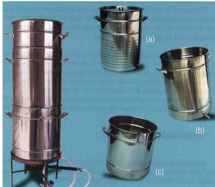
**Figura 8 - Extrator de suco (Fonte: RIZZON *et al.*, 1998).**
