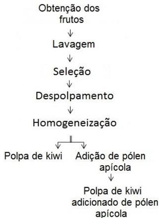
Figura 2 – Fluxograma do processo de tratamento da polpa.
