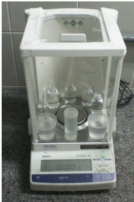
Figura 11 - Balança analítica saturada com água destilada para análise da taxa de Absorção de água e coeficiente de difusão.
