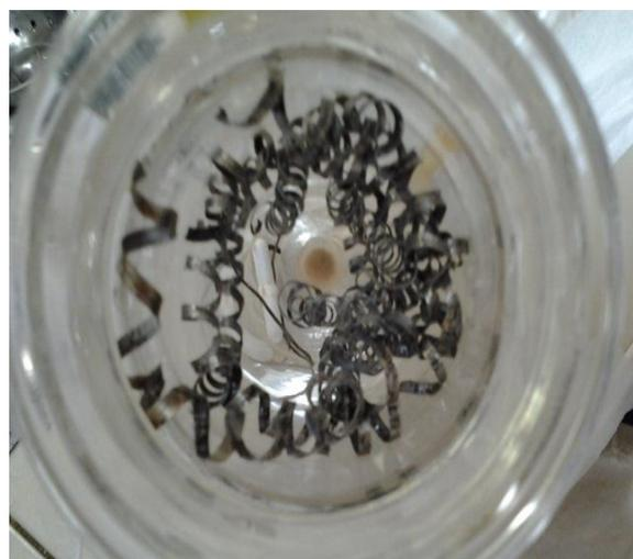
Figura 3 - Envolvimento do bulbo de quartzo por aparas de ferro.
