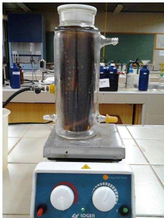
Figura 9 - Tratamento com peróxido de hidrogênio e aparas de ferro.
