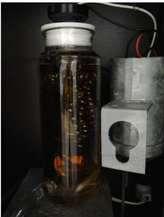
Figura 8 - Tratamento com peróxido de hidrogênio, aparas de ferro e ultravioleta.
