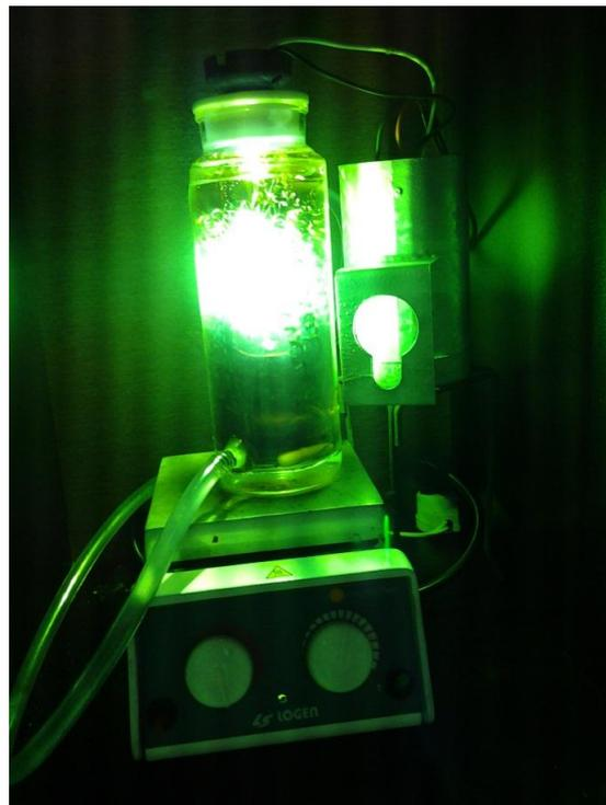
Figura 7 - Tratamento com peróxido de hidrogênio, aparas de ferro e ultravioleta.
