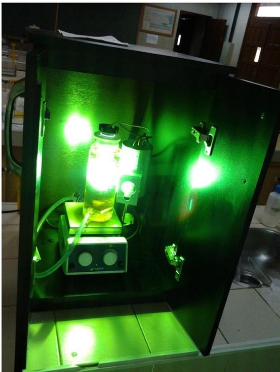
Figura 6 - Tratamento com peróxido de hidrogênio e ultravioleta.
