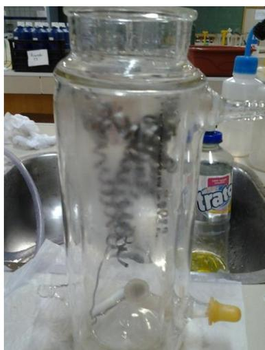
Figura 2 - Envolvimento do bulbo de quartzo por aparas de ferro.
