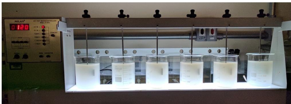
**Figura 6 - Teste da utilização do biopolímero extraído da *P. aculeata* Miller no processo de coagulação/floculação para a avaliação no tratamento de efluente lácteo sintético (Jar-Test)**
