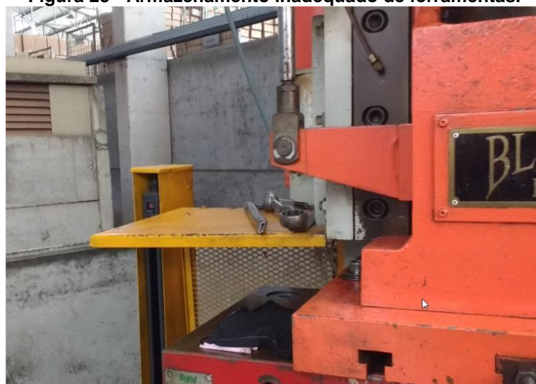
Figura 23 - Armazenamento inadequado de ferramentas.
