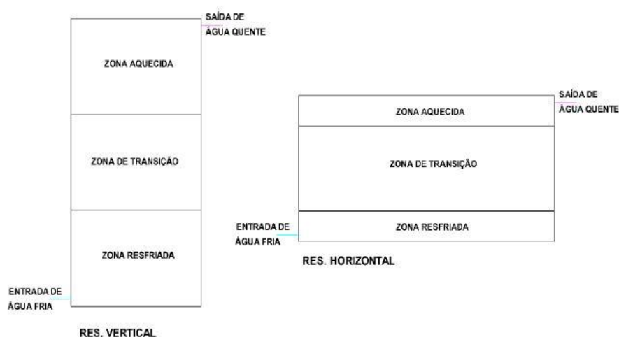
Figura 14 – Estratificação térmica da água em reservatório vertical e horizontal.
