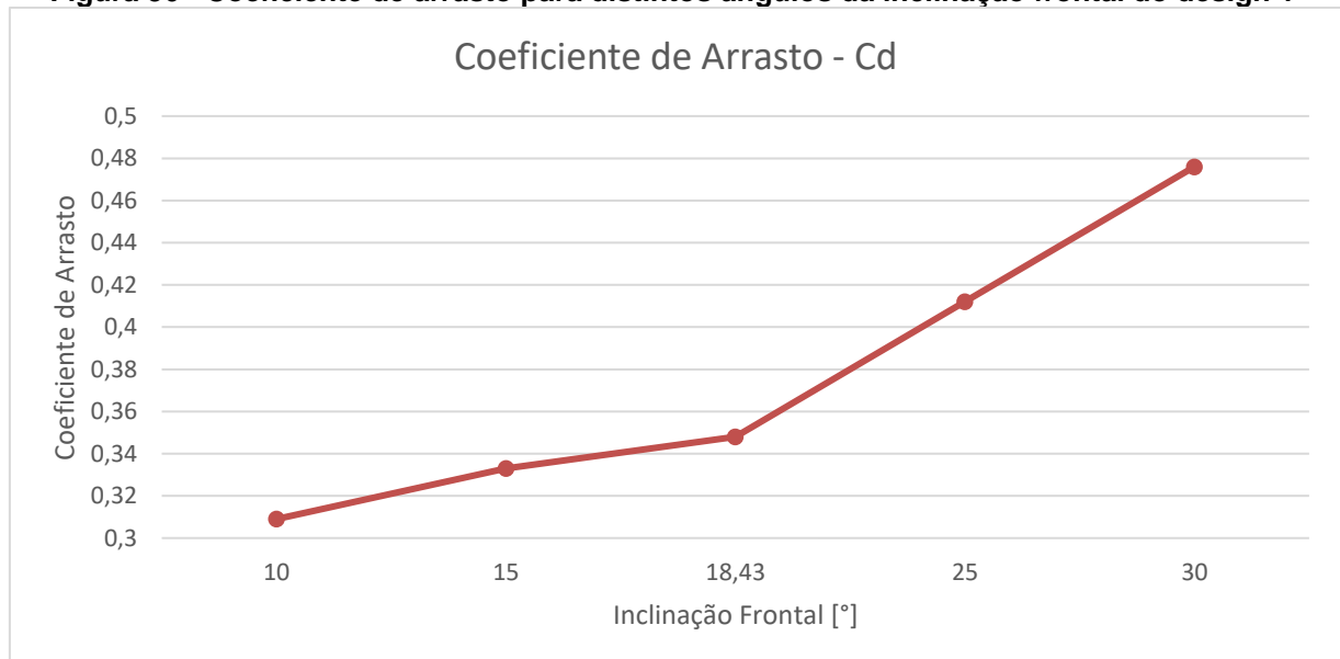
Figura 36 - Coeficiente de arrasto para distintos ângulos da inclinação frontal do design 1
