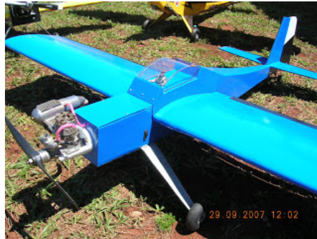
Figura 15: Aeromodelo que utiliza asa média
