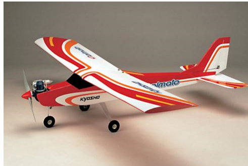
Figura 14: Aeromodelo que utiliza asa alta
