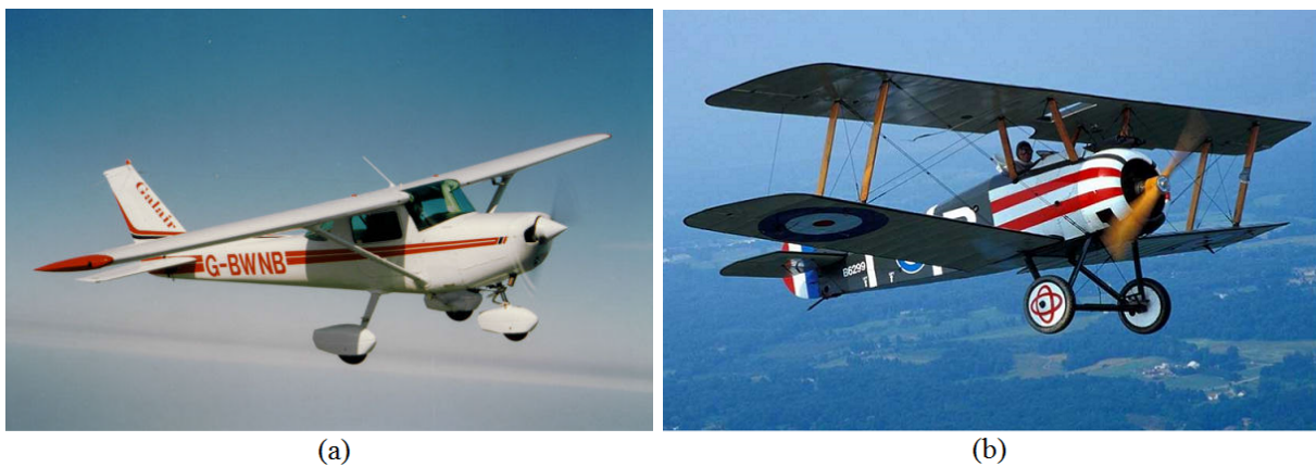
Figura 7: (a) Avião monoplano e (b) avião biplano
