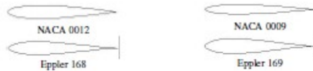
Figura 32: Perfis aerodinâmicos mais utilizados nas empenagens da competição SAE AeroDesign
