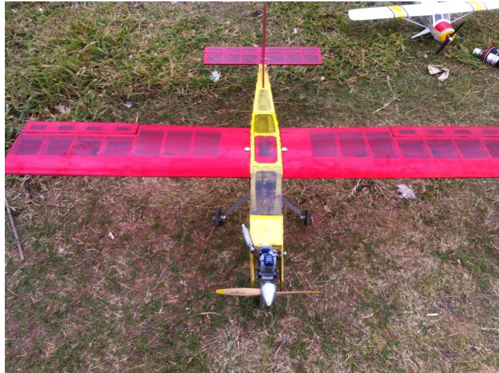
Figura 39: Aeromodelo com o grupo moto propulsor do tipo tractor
