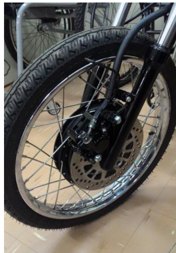
Figura 29 - União da roda e seus componentes ao garfo de direção
