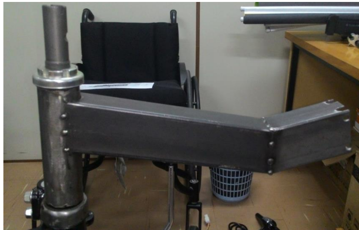
Figura 30 - União do garfo de direção e estrutura de sustentação do frontbike
