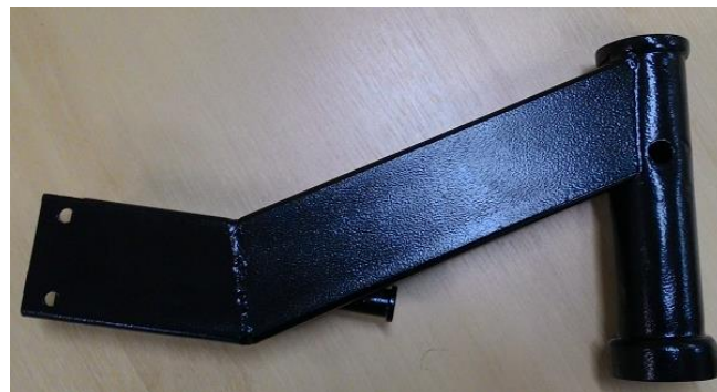
Figura 22 - Vista lateral da estrutura de fixação do frontbike
