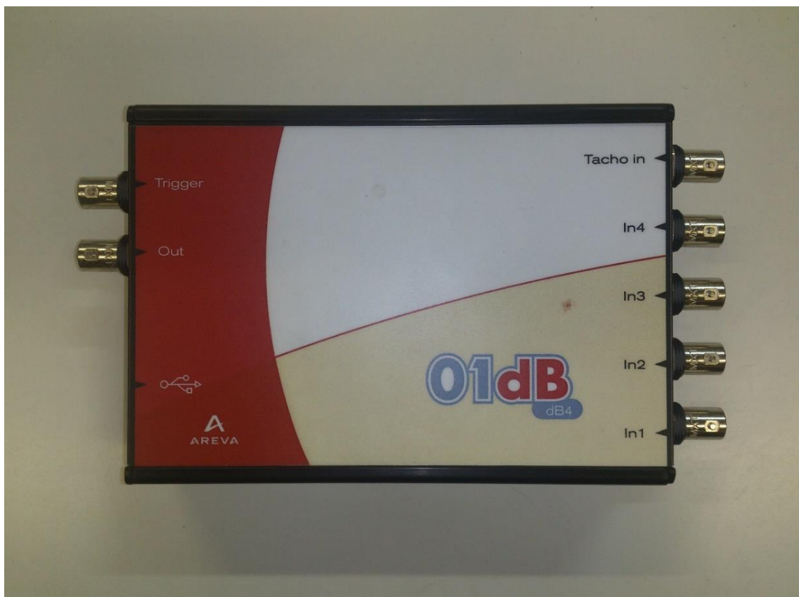
Figura 26 - Analisador de sinal Fonte: Autor.
