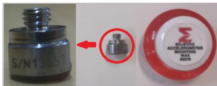
Figura 25 - Acelerômetro e cera de fixação Fonte: Autor.
