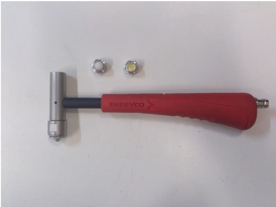
Figura 23 – Martelo de Impacto e suas ponteiros Fonte: Autor.
