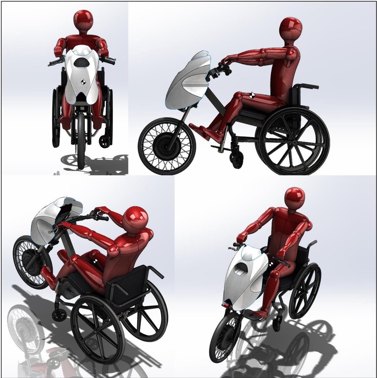
Figura 28. Protótipo Virtual do Trike em sua Concepção Final. Fonte: do Autor.
