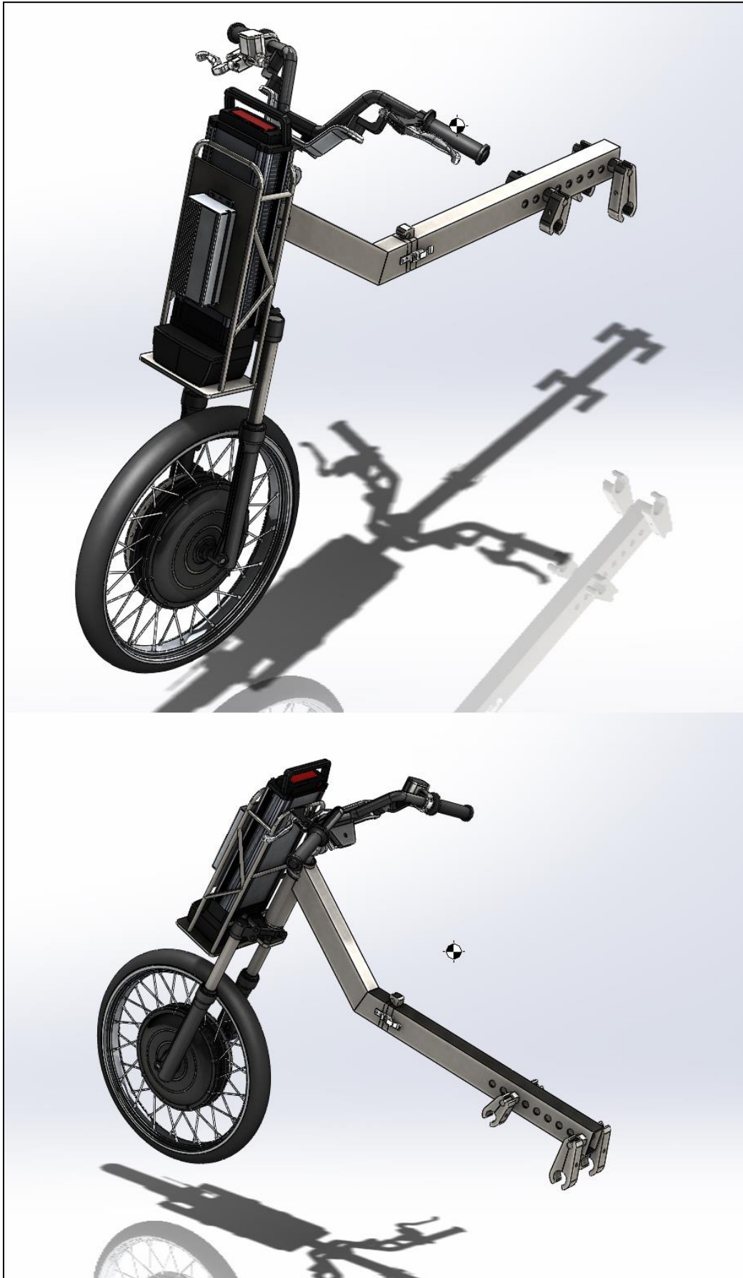
Figura 22. Front Bike e Chassi com as Conexões da Cadeira de Rodas. Fonte: do Autor.
