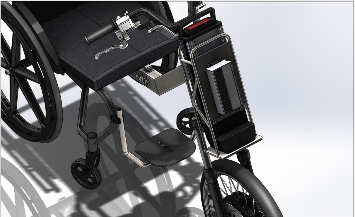
Figura 27. Detalhe para o Sistema de Direção e Amortecimento. Fonte: do Autor.
