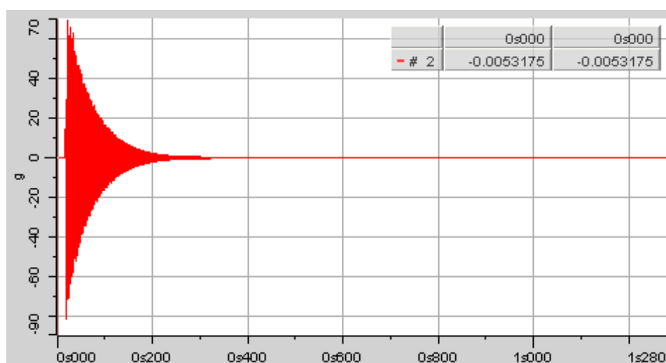
Figura 19 – Fator de amortecimento para o corpo de nodular livre-livre. Fonte: Os autores (2014).
