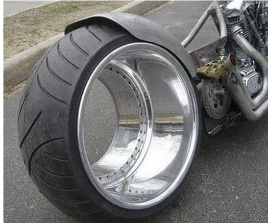
Figura 3 - Roda sem raios utilizada na motocicleta Fonte: Google Imagens – C
