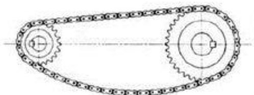
Figura 9 – Transmissão por corrente de rolos Fonte: Google Imagens G
