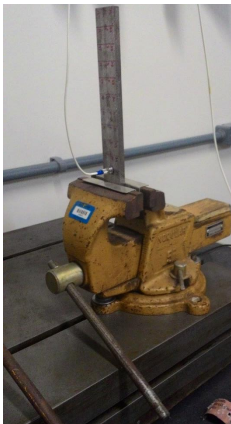
Figura 30: Fixação da barra de aço 1020 na morsa. Fonte: Autora.
