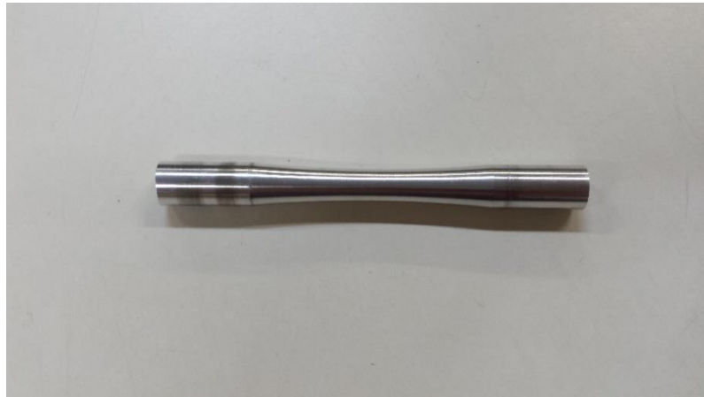
Figura 22- Corpo de prova conforme Manual de instruções R.R. Moore Fonte: O Autor.
