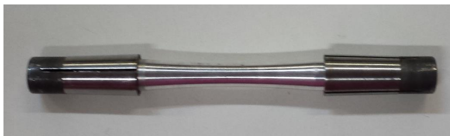
Figura 28 - Corpo de prova inserido nos dois aros Fonte: O Autor.
