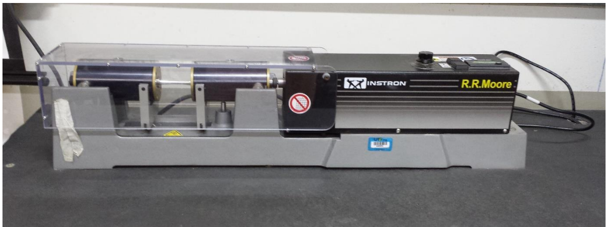
Figura 44 - Máquina de ensaios de fadiga por flexão-rotativa Fonte: O Autor.
