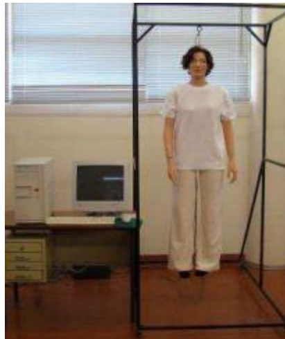
Figura 3 - Manequim térmico usado para determinar o isolamento de roupas Fonte: Teixeira et al. (2011 p. 03).
