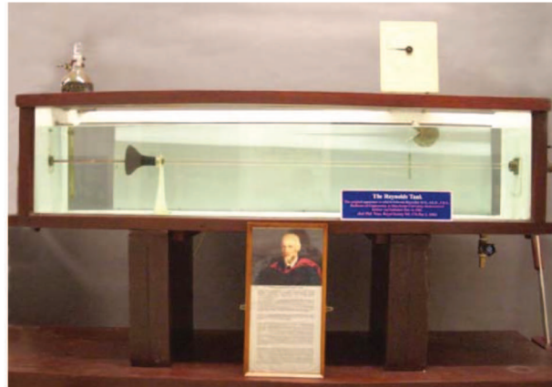
Figura 6: Aparato original de Reynolds na Universidade de Manchester
