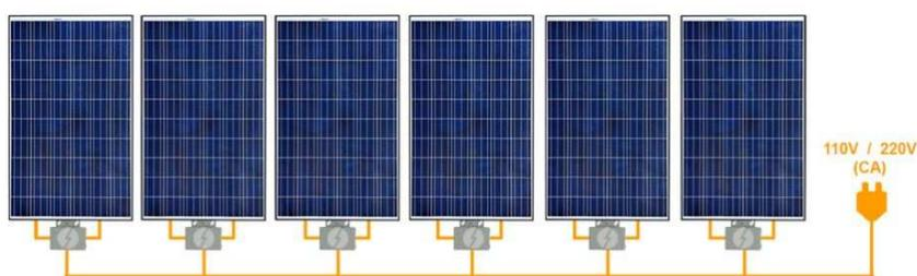
**Figura 25: Exemplo de *string* para associação de painéis com micro inversores.**
