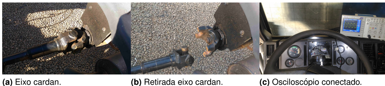
Figura 21: Ensaio para obter sinal do sensor do veículo.
