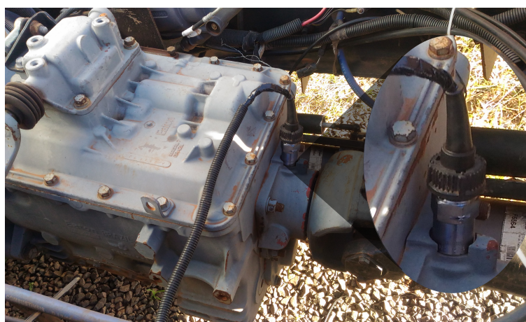
Figura 20: Localização do sensor no veículo. Fonte: Autoria própria, 2016.
