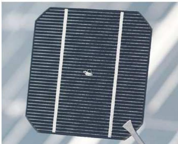
**Figura 8: Célula fotovoltaica de silício mono cristalino**
