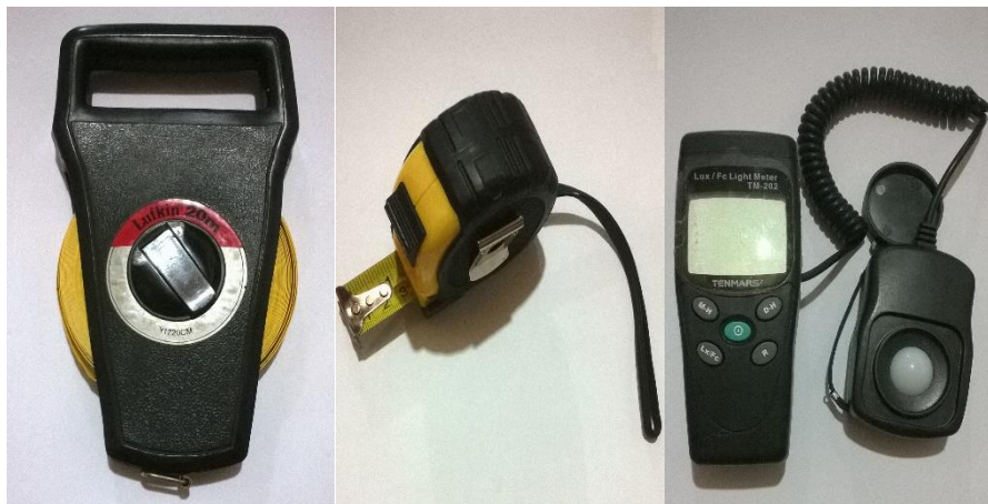
Figura 8 - Equipamentos utilizados em campo: Fita métrica, trena métrica e luxímetro (TENMARS).
