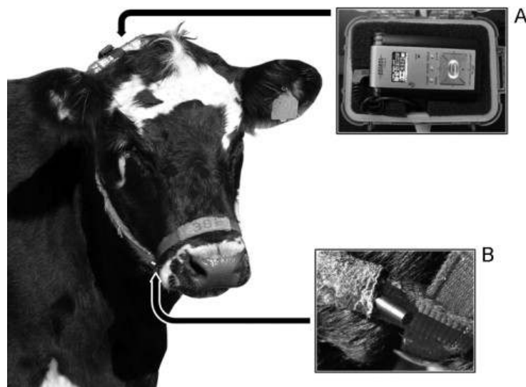
Figura 8 – Sistema de gravação instalado em uma bezerra. (A) o gravador em uma caixa protetora. (B) microfone.
