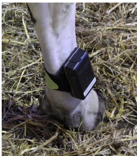
Figura 7 – Pedômetro utilizado no sistema RumiWatch . Fonte: Kajava et al. (2014).
