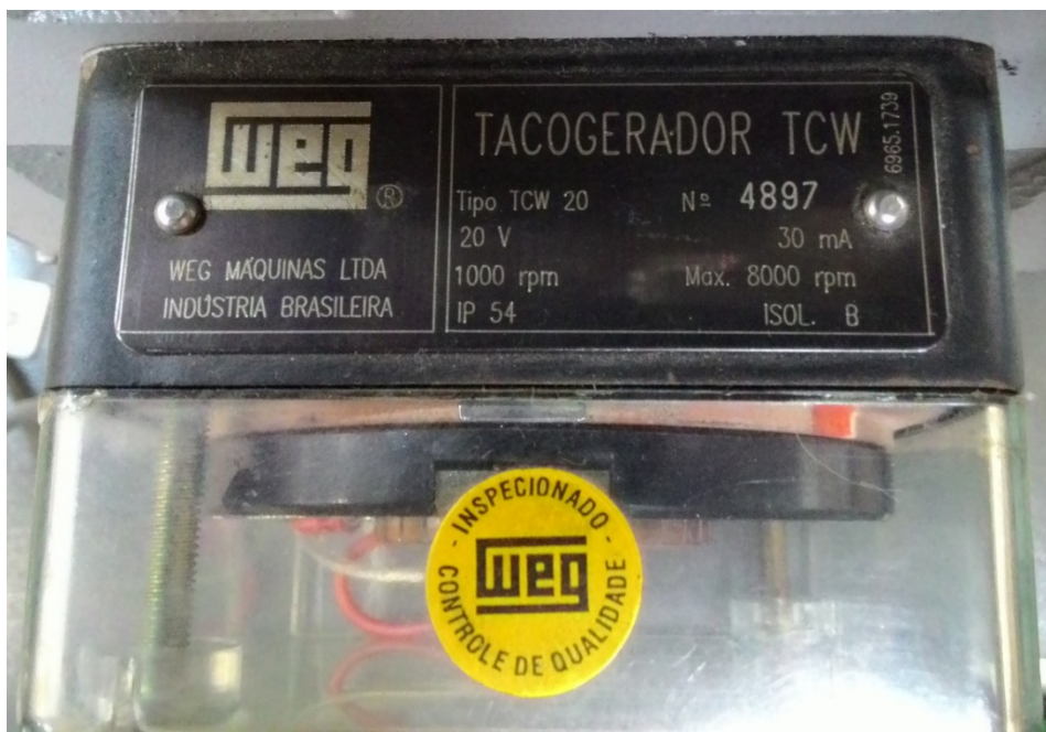
Figura 18: Dados de placa do Tacogerador Fonte: Autoria Própria.
