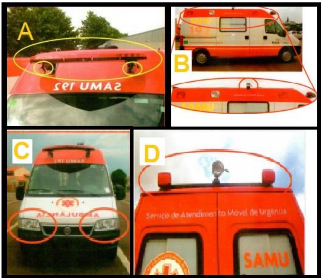
Figura 3: Iluminação Extra Presente nas Ambulâncias do Samu Fonte: Manual Prático do Usuário
