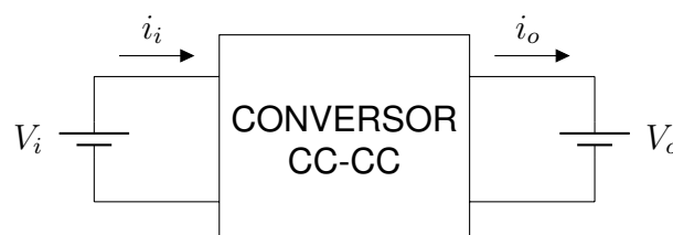
Figura 5: Representação simplificada de um conversor CC-CC Fonte: Adaptado de Martins e Barbi (2006).
