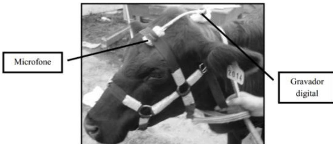
**Figura 8: Novilha equipada com microfone à frente conectado ao gravador digital.**
