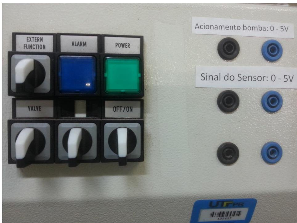
**Figura 34 - Chaves e bornes para ligação com a placa de aquisição de dados.**
