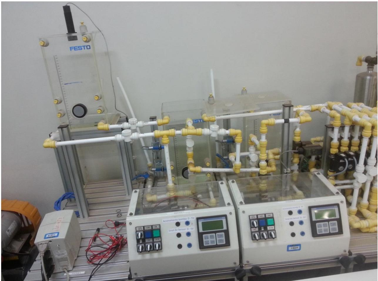
**Figura 15 - Bancada de Nível e Vazão.**
