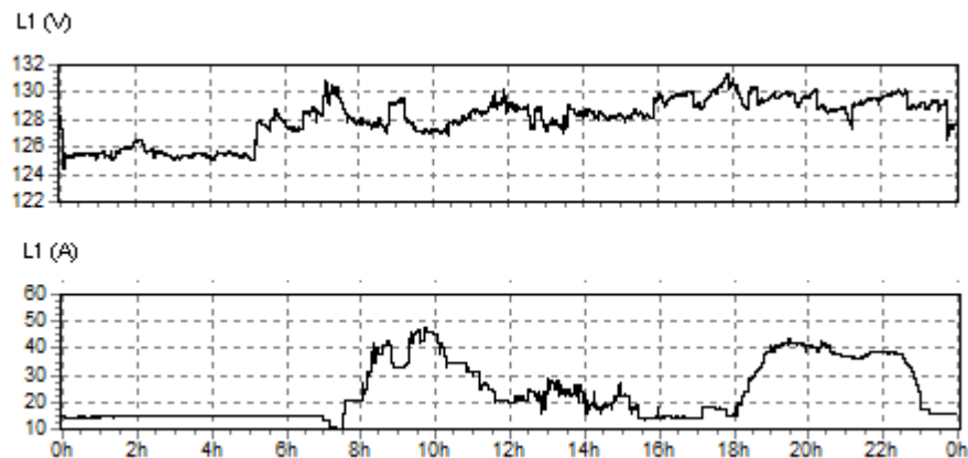
Figura 29 - Curva diária de tensão e corrente (TR4) - 12/04/2013 (sexta-feira) Fonte: Autoria Própria
