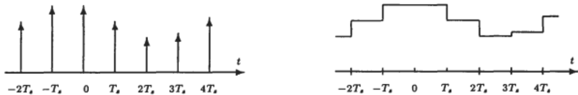
Figura 14 - Operação do dispositivo retentor.
