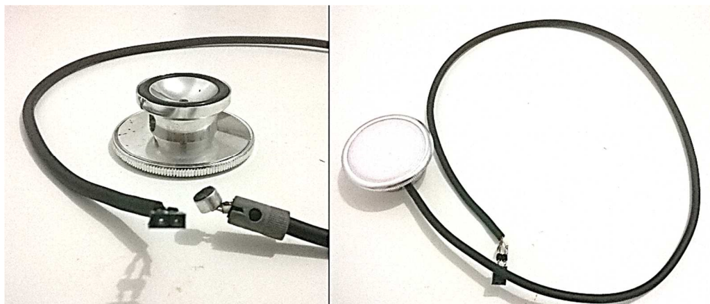
Figura 26 - Microfone de eletreto acoplado a um estetoscópio convencional.
