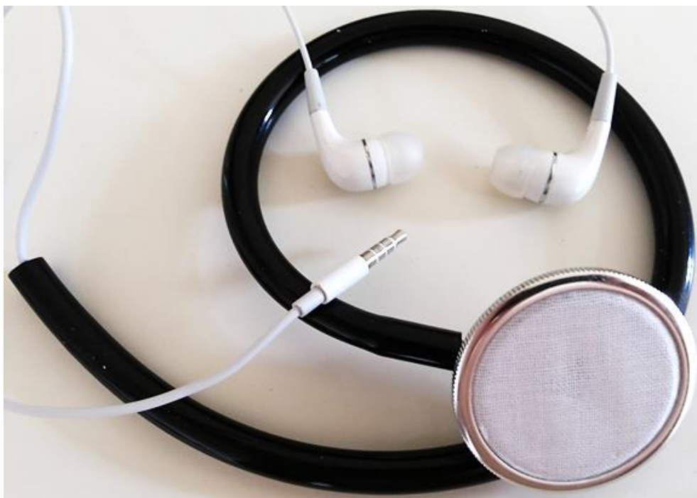
Figura 32 – Transdutor do protótipo. Fonte: Autoria própria.
