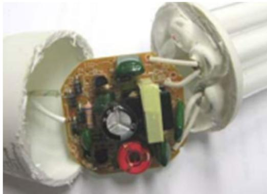
**Figura 8 – Exemplo de circuito interno de uma LFC**
